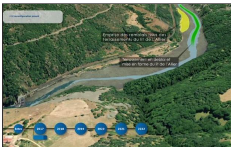
■ Les sédiments sortis de la retenue seront terrassés sur les berges, puis végétalisés. Photo DR
